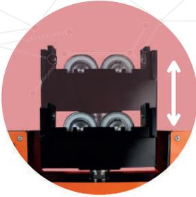
La **altura** de la base también **puede ser modificada** para ajustarse a rotores de diferente diámetro.
