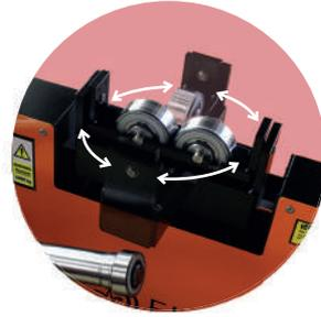
La base de la **SBS** tiene la capacidad de rotar sobre su propio eje y tiene un inclinamiento horizontal de 45°. Esto para proteger los ejes y proveer máxima durabilidad.
