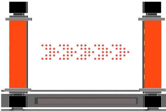
Los **pedestales** de la EI-500 **pueden ser ajustados** para adaptarse a una amplia variedad de ejes.
