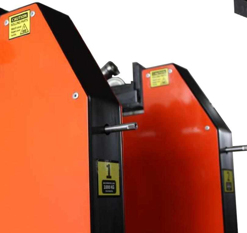
Las bases flotantes de la EI-500 son fabricadas **resistentes y ligeras** para reducir la inercia mecánica.
