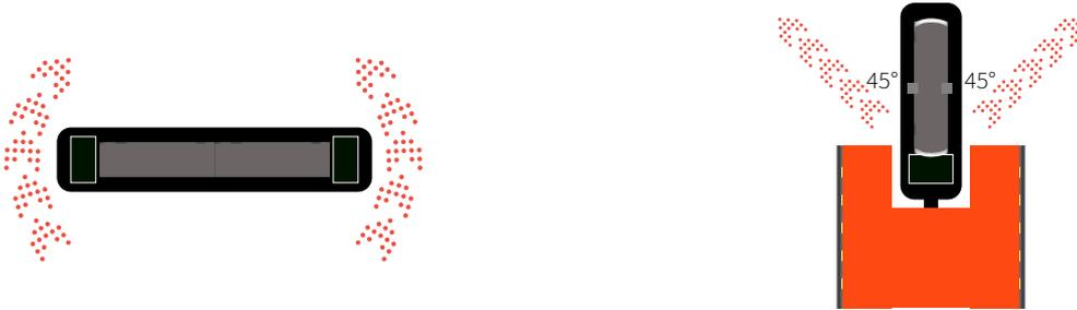
La base de la **SBS** tiene la capacidad de rotar sobre su propio eje y tiene un **inclinamiento horizontal de 45°**. Esto para proteger los ejes y proveer máxima **durabilidad**.
