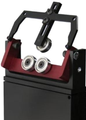
Accesorio requerido para asegurar rotores con altos niveles de vibración o montados en cantilever.
