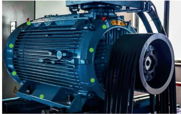
Con la ayuda de cualquier acelerómetro, puede detectar hasta 15,000Hz en cualquier eje y con una precisión muy alta. Con esto, será capaz de detectar problemas de rodamientos, problemas de caja de engranajes y muchos más.
