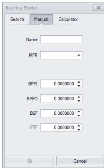
Los Rodamientos pueden ser creados manualmente usando frecuencias de fallas calculadas o para aquellas que el fabricante del rodamiento provee.
