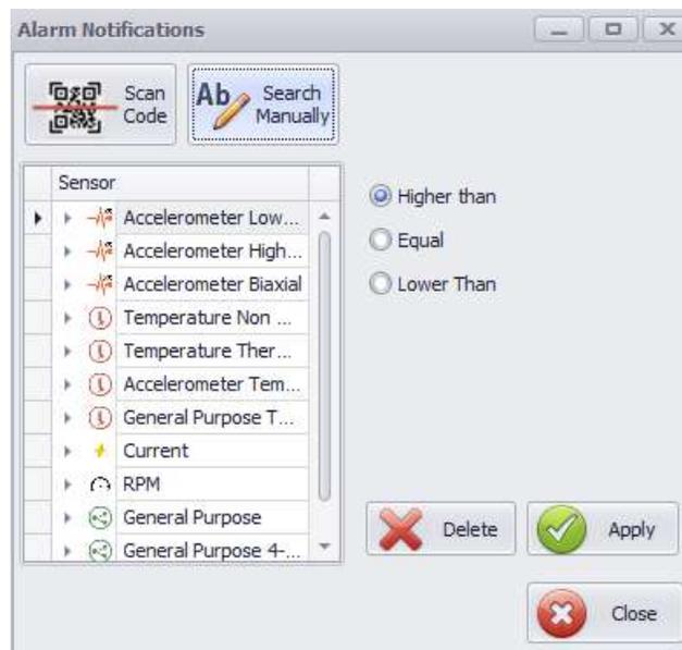
**Nota:** Los sensores de vibración y GPIO también puede medir, tanto los parámetros designados, como la temperatura. Las alarmas para la temperatura se configuran por separado y se puede encontrar una subsección en la configuración de las alarmas llamada "Temperatura del acelerómetro" y "Temperatura de Propósito General", según sea el caso.
