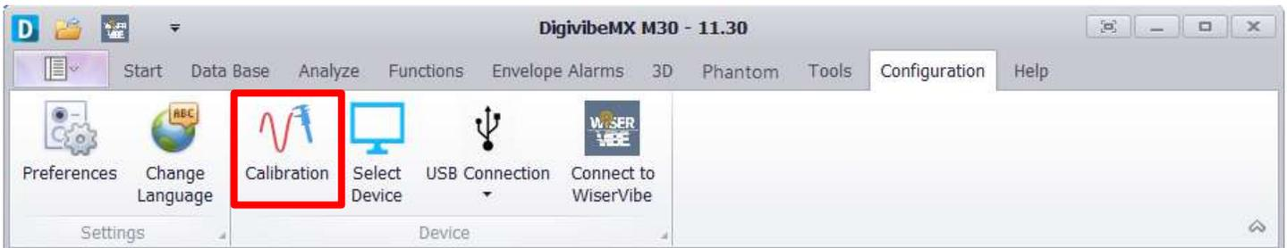
Esto abrirá la ventana de calibración. Aquí, seleccione la interfaz deseada, a continuación, seleccione el canal en el cual tenemos instalado su dispositivo calibrador y luego de click en **Calibrate**.
