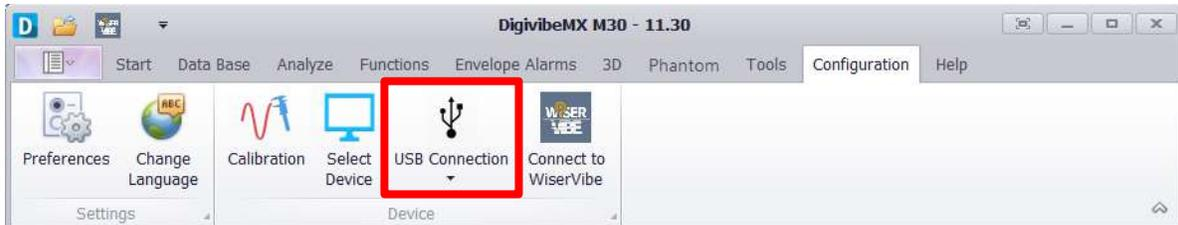
Para usar nuestro WiSer3x en DigivibeMX de click en el botón para cambiar de conexión USB a **Conexión Wi-Fi**. Después, oprima el botón en su WiSER3X y acceda a la red EIWISER en su computadora.
