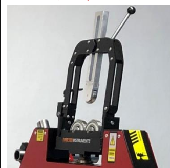
Roulements en porte-à-faux pour arbres courts
